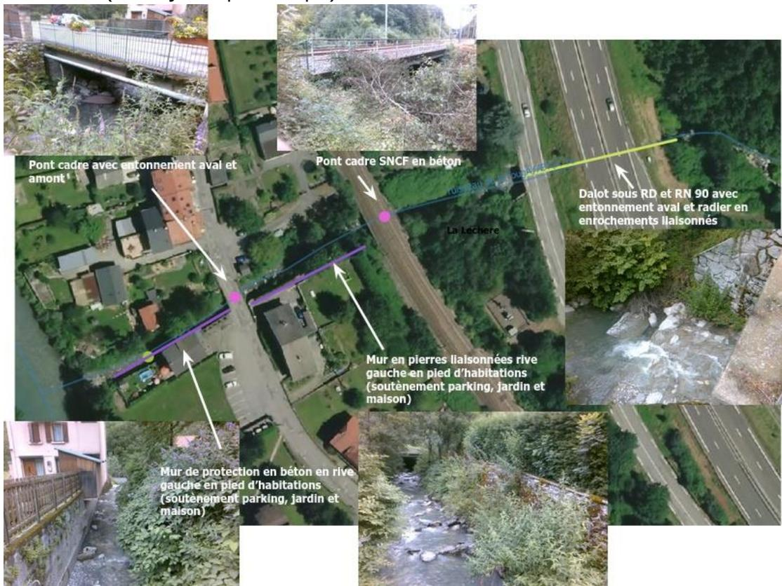
Cartographie des ouvrages hydrauliques (APTV, 2021)
